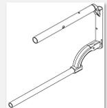
Telaio "Hemi" per altezza seduta anteriore da 370 a 430 mm per Compact con portapedane estraibili.
